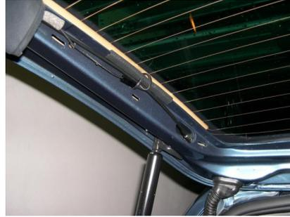
Nun kann der um die untere Heckklappenverkleidung verlaufende Teil vorsichtig um diese herum abgehoben und die ganze Verkleidung abgenommen werden.
