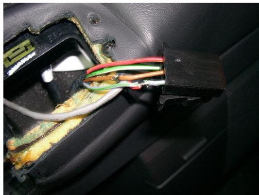
Am freien Ende des Kabels kann nun polungsgerecht die LED angelötet werden. Jetzt ist sicherheitshalber ein Funktionstest durchzuführen (siehe Punkt 6). Anschließend wird mit der Rundfeile der vorhandene Ausschnitt in der Griffmulde entsprechend der LED-Größe geweitet und die LED mittels Heißkleber fixiert.
