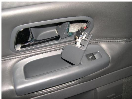
Nach Lösen der ggf. vorhandenen Steckverbindung kann der Einsatz vollständig entfernt werden.
